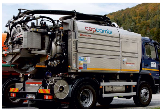
Samochód Mercedes-Benz ATEGO (WUKO) – samochód przeznaczony do czyszczenia sieci kanalizacyjnej FOT. ZAOPPRADZIE SP. Z O.O.
