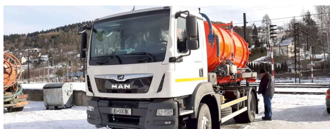
MAN TGM – samochód asenizacyjny do przewozu nieczystości płynnych FOT. ZAOPPRADZIE SP. Z O.O.
