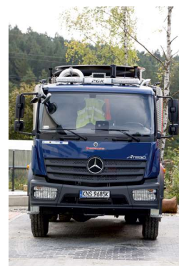
Samochód Mercedes-Benz ATEGO (WUKO) – samochód przeznaczony do czyszczenia sieci kanalizacyjnej FOT. ZAOPPRADZIE SP. Z O.O.
